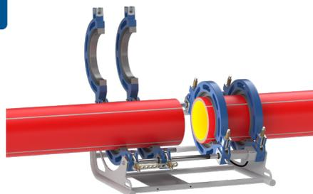
Концы труб, устанавливаемые в центратор, очищаются от грязи, трубы выставляются по оси и закрепляются в сварочном аппарате.
