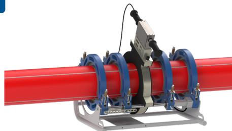
Устанавливается нагреватель, трубы сводятся и оплавляются, нагреватель удаляется.
