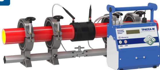
Трубы устанавливаются внутрь детали (фитинга) по меткам. Соединение фиксируется с помощью позиционера. Подключается сварочный аппарат.
