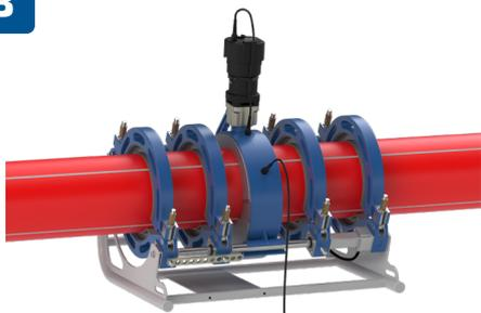
В аппарат устанавливается торцеватель, соприкасающиеся поверхности труб обрабатываются, торцеватель убирается и производится регулировка смещения кромок труб (норма – меньше 10% толщины стенки). После регулировки смещения при необходимости производится дополнительное торцевание.
